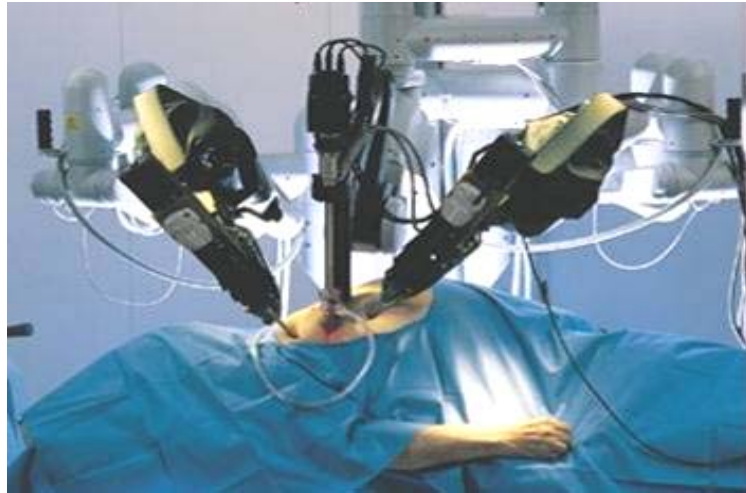
Figuur 4-7: Robotchirurgie; het bedieningspaneel van de chirurg, robotarmen, hendels en chirurgische instrumenten (bron: Intuitive Surgical)
